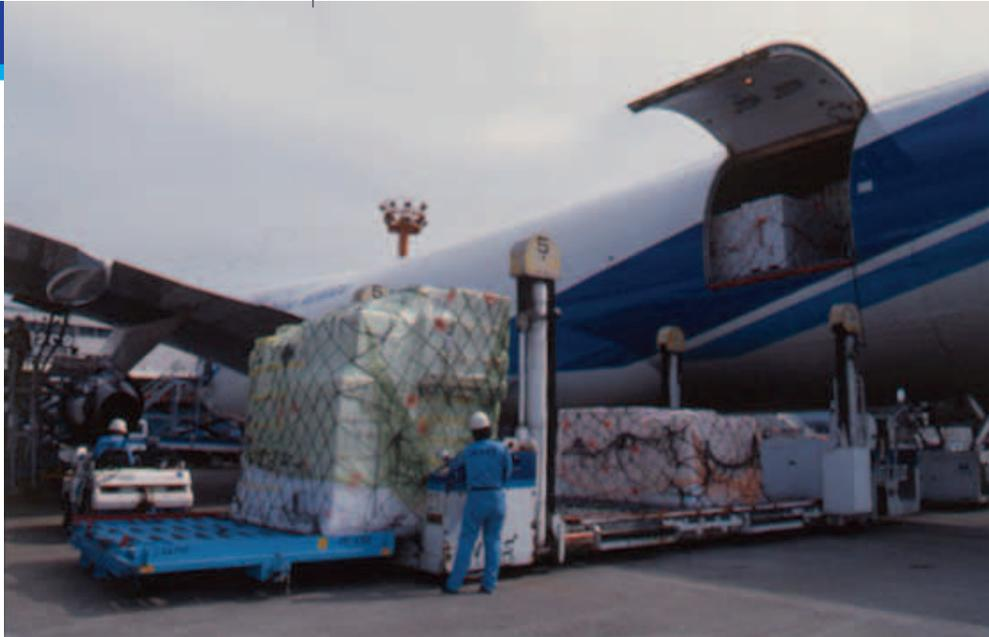
当初の747Fではオプションだったサイドカーゴドアだが、実際の搭載作業ではこちらが主に使われることが多い。後付けも容易なため、旅客型747を貨物機に改造する場合にも装備される。Photo: Yohichi Kokubo
