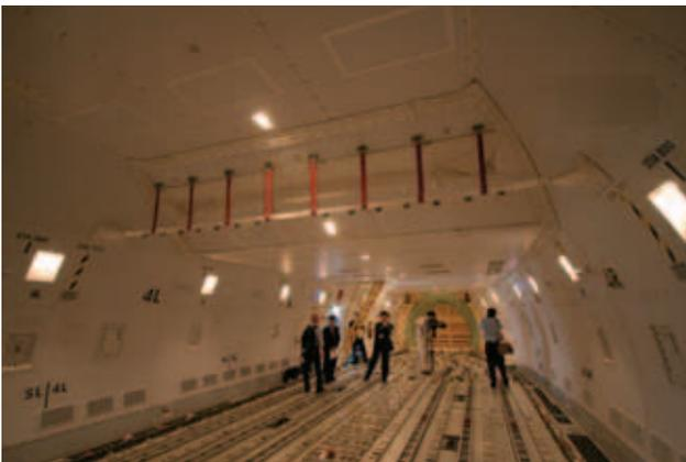
メインデッキ貨物室の天井はアッパーデッキ部分が少し低い。そのためノーズカーゴドアだけでは後部の高い天井部分を有効に活用できない。天井が低くなる境界部分には防護ネットが設けられている。Photo: Konan Ase
