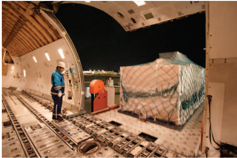
747Fでは最低2人のスタッフが いれば貨物の積み下ろしを行 うことができるようになってい る。ただしNCAでは1便あたり11~ 12名のスタッフを配して、より迅 速かつ効率的に積み下ろし作 業を実施している。
