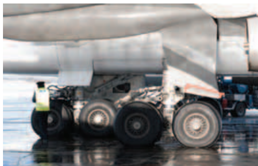
旅客機では最近になって 常識化したカーボンディ スクのブレーキは、貨物機 では747クラシックの時代 から装備されていた。写 真は747-200Fのメイン ギア。
