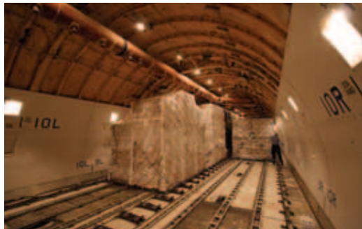
天井には操縦用のケーブルやエアコン用ダクトなどがもみだしになって見える。貨 物機とはいえ生きた動物や温度管理の厳しい精密機械などに対応して最適な 温度に調整できるようになっている。
