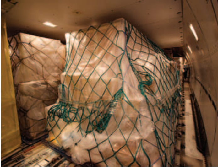
メインデッキにぎっしりと積み込まれた航空貨物。 747-400Fのメインデッキの容積は605m 3 にもなる。 Photo: Konan Ase
