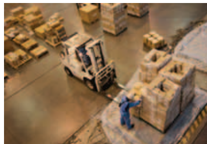
搭載貨物の積みつけ。作業しやすいよう高さを変更できる台の上にパレットを置き、貨物を積み上げていく。またこの台は貨物の正確な重量を計る機能もある。
