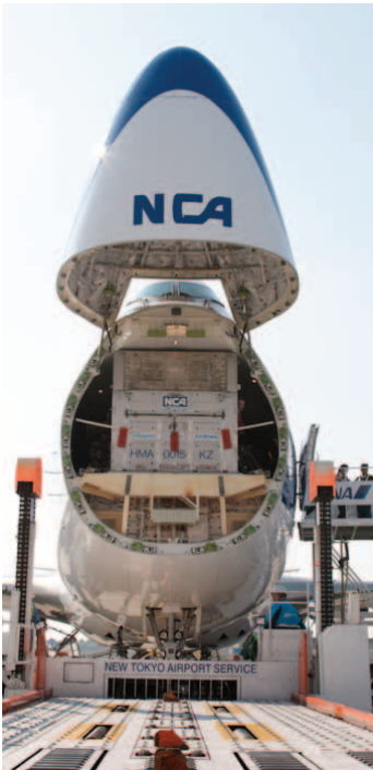
メインデッキへの貨物搭載風景。壁面に書かれた「9R」などの記号がポジションを表わしている。
