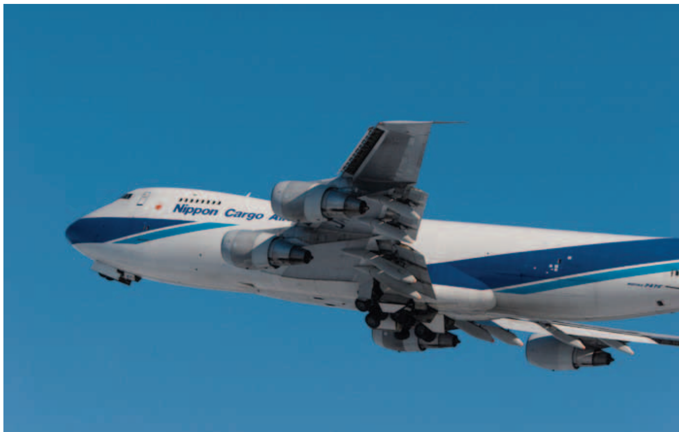
離陸するNCAの747-200F。重心位置はだいたい主翼付け根の中央付近(中央エンジンのやや外側、MCA=空力平均翼弦前縁から25%程度)になるようにする。
