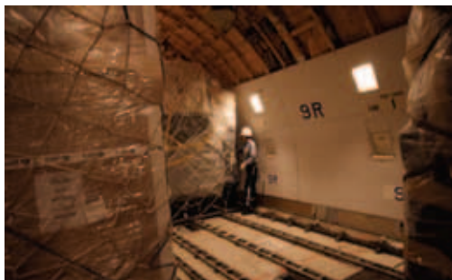
メインデッキへの貨物搭載風景。壁面に書かれた「9R」などの記号がポジションを表わしている。
