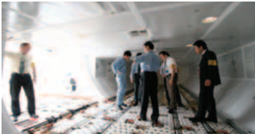
NCAの747-400Fのローワーデッキ。基本的には旅客型の747の床下貨物室と同じだが、最後尾のバルク(バラ積み貨物室)をやや小さくしてコンテナ2個を余計に搭載できるようにしている。
