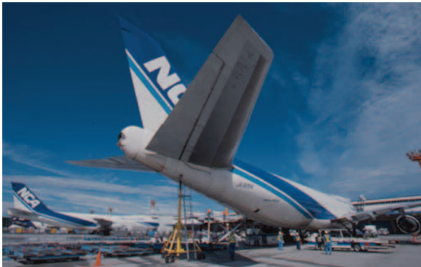
747Fの胴体後部の下にあてがわれたテールスタクション。尻餅を防止するためだが、これを取り付けた機体部分には大きな荷重に耐えられる強度はない。テールスタクションは後部に過度の荷重がかからないようにするためのセンサーのような役割と考えた方がいい。
