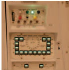
747-400Fノーズカーゴドアの操作盤。グリーンランプは固定用ラッチの確認用。全部で16個のラッチでがっちり固定する。
