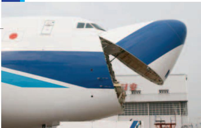
ノーズカーゴドアを開放作業中。悪天候が飛行機に影響するのは主に離陸時だが、貨物機では駐機中のカーゴドアの開閉にも風速制限がある。強風時に家のドアを開け閉めするには力が必要だが、その数十倍もある巨大なカーゴドアが風から受ける力は想像を絶する。しかし高速道路を走るのに匹敵する風速下でも開閉できる。
