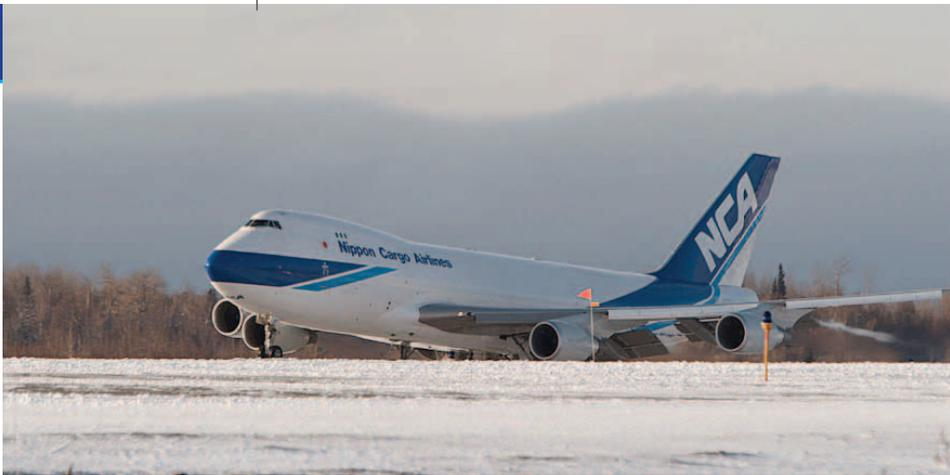
アンカレッジ空港に着陸するNCAの747F。貨物機は欧米にノンストップで飛べる燃料を積みよれば、アンカレッジを経由してもより多くの貨物を積み込む方が収益が高くなる。ただし着陸重量は旅客機よりも重くなりがちだ。
