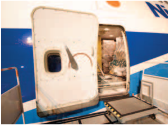
747Fのメインデッキドア。旅客型747と違ってスライドシートを収納するふくらみがないことがわかる。もちろんモードセレクターレバーもない。
