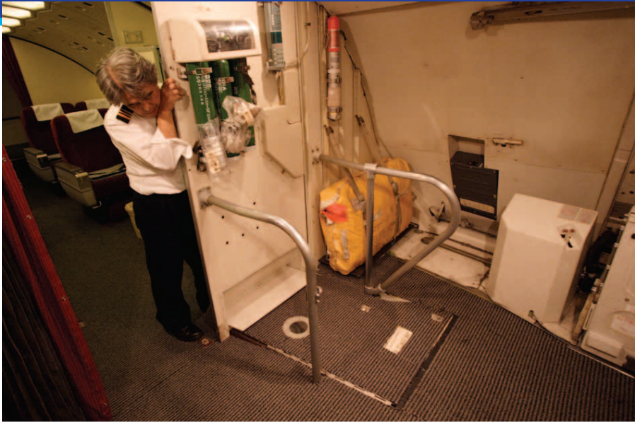
これがメインデッキとの階段開口部を閉鎖した状態。床の四角い部分がドアだ。その向こうに見える黄色い包みは救命ポート。
