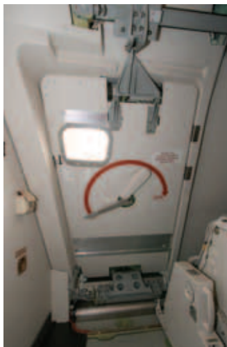
747Fアップパーデッキ非常口のドアサイドに用意されているスライドシート収納箱。運航中はこれをドア前にセットしておく。
