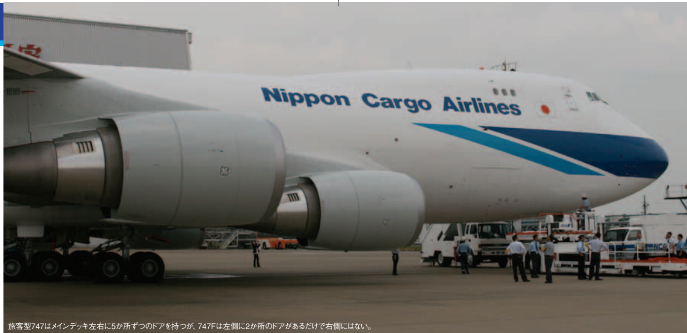
旅客型747はメインデッキ左右に5か所ずつのドアを持つが、747Fは左側に2か所のドアがあるだけで右側にはない。
