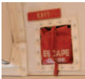
メインデッキドアの上部に収納されている脱出用ロープ。これを引き出して地上にたせれば、不安定ながら降りることができる。
