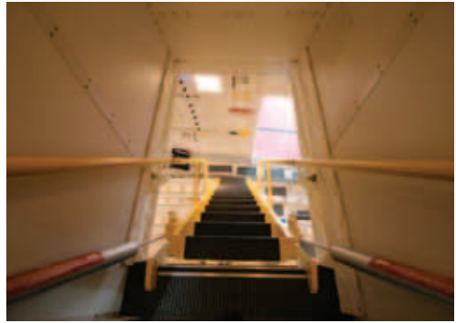
アップデッキから見たメインデッキとの連絡階段。飛行中はアップデッキ開口部は閉鎖されるが、そのドアは気密構造ではない。
