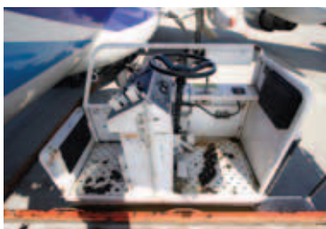
ハイリフトローダーの運転台は、車輛の移動に備えた部分と向かい合わせに、貨物の積み下ろし操作を行う部分とがある。
