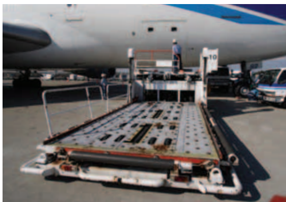
ローワーデッキ用のハイリフトローダー。747Fのローワーデッキは旅客型と共通だから、ターミナルビル周辺でも見られる。
