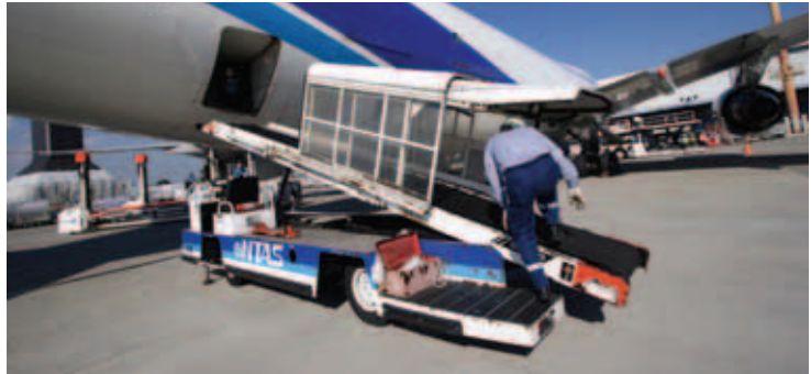
ばら積み貨物用のバルクローダー。747Fのバルクには約4トンの貨物を搭載できるが、すべて手作業で積み下ろしする。
