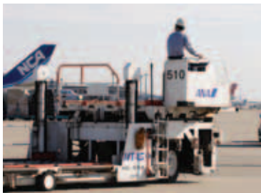
移動するハイリフトローダー。運転台にはシートがなく、立ったままで運転する。
