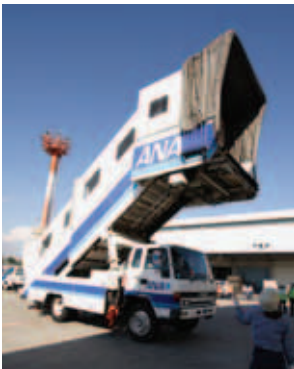
到着した飛行機にアプローチするタラップ車。運転席の天井はガラスサンルーフになっており、機体の位置を確認できる。
