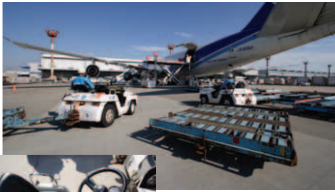
ばら積み貨物用のバルクローダー。747Fのバルクには約4トンの貨物を搭載できるが、すべて手作業で積み下ろしする。
