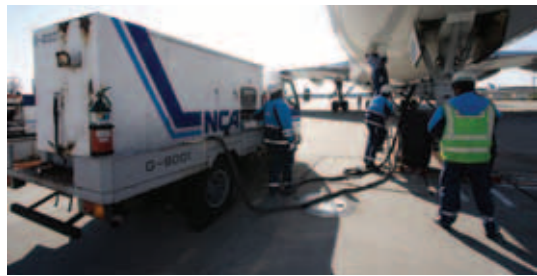
飛行機がスポットインするとすぐに電源車が接続され、エンジン停止後の電気供給に備える。
