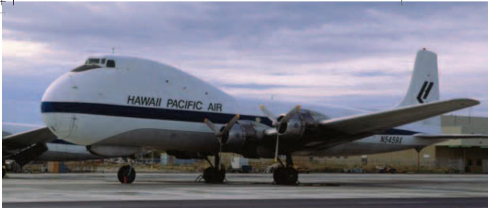
DC-4を改造し、ノーズカーゴドアを備えたATL-98カーベア。一度見たら忘れないユニークなスタイルだが、コックピットを上方に設置し、ノーズからの搭降載を可能にしたコンセプトは747Fと同じだ。
