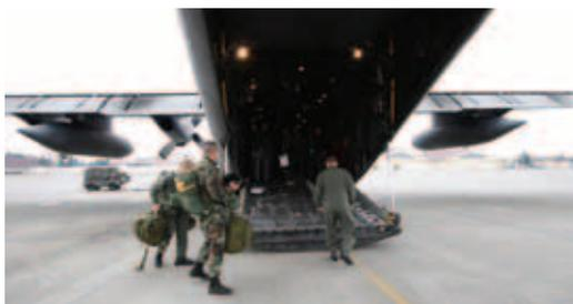
軍用輸送機C-130の後部ドア。低床式のため、貨物の積み降ろしが容易になっている。
