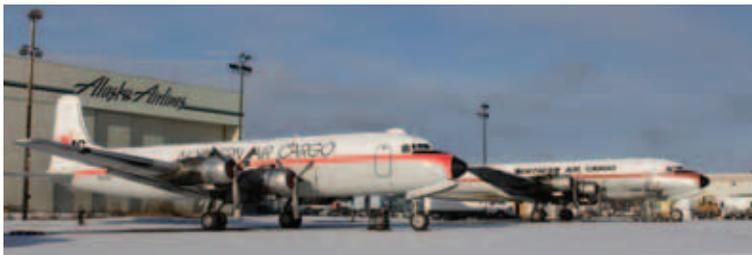
DC-4の流れを受け継ぐ、DC-6貨物機。DC-4以降は降着装置がDC-3の尾輪式から前輪式に変更されたことにより、地上姿勢が水平になり、旅客、貨物とも作業性が大幅に改善された。
