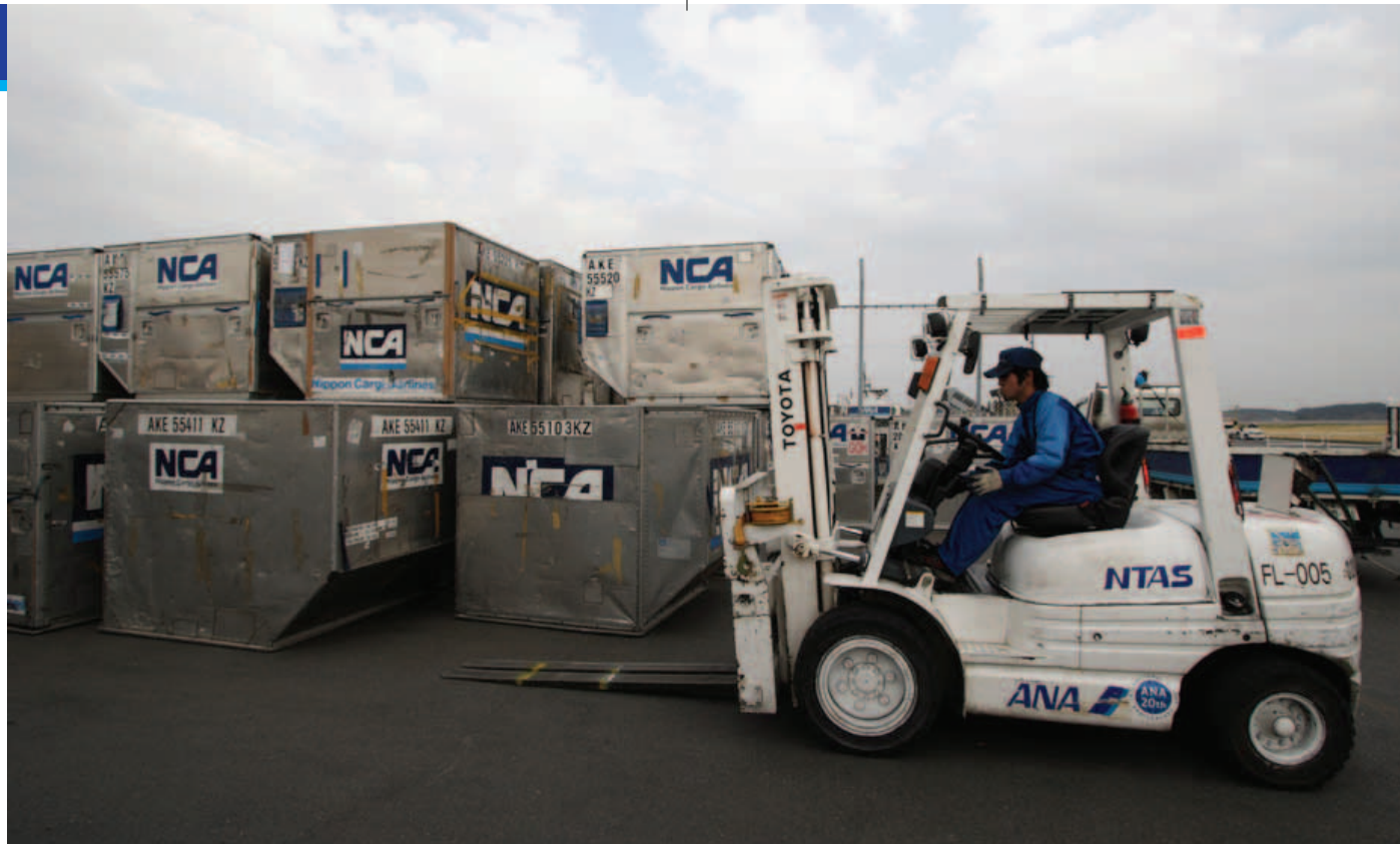
外形は同じでも保冷品用や衣料品用などさまざまなコンテナが用意されている。
