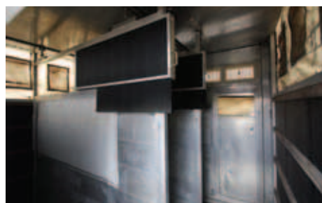
競走馬などを運ぶためのコンテナ。内部は三つに仕切られており立ったまま運ばれる。
