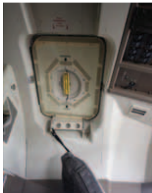
コックピット天井の緊急脱出ハッチ(カバーをはずした状態)。地上までは約10メートルの高さがあるため、専用ハーネスを装着したうえで緩降下用のワイヤーに接続して一人ずつ降りる。ワイヤーは8本用意されており、これが747-400Fの定員となる。
