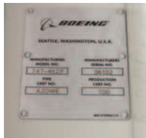
L1ドアの開口部に固定されたプレート。JA05KZは初めてNCAが自社で発注した機体であり、型式名はNCAのカンパニーコード「KZ」をつけた747-4KZFとなっている。
