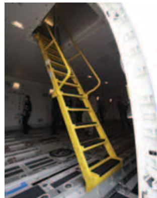
アップパーデッキに上るための急な階段。折り畳んで天井部分に収納することができる。
