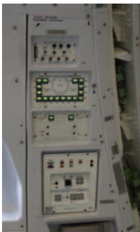
ノーズカーゴドアの横にあるコントロールパネル。上部はノーズカーゴドアの操作パネルとロック確認のためのライト。下はノーズカーゴドアから積み下ろす貨物の移動をコントロールするためのパネル。
