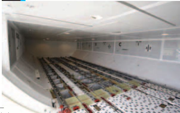
前方の床下貨物室。主翼後方にも同様の貨物室とバラ積み用のバルク貨物室とがある。メインデッキと比べるとかなり小さいが、床下部分だけでも合わせるとDC-8貨物専用機と同じくらいのキャパシティがある。
