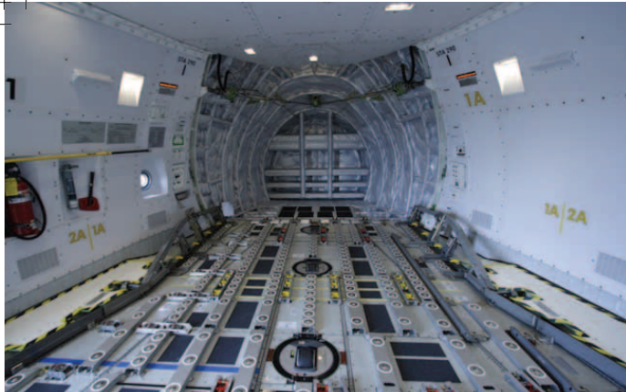
閉じられたノーズカーゴドア方向を見る。内装パネルの張られていない部分がドア。左の壁面に消火器が装備されているが、上空では窒息消火方式がとられるため、これは地上での火災に対応するためのものだ。
